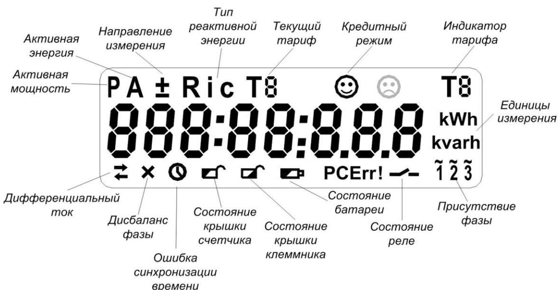
Рис. 6.1. Вид символьного дисплея счетчика Lite в тестовом режиме. Все сегменты активны.
